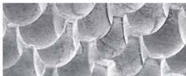
Surface structurée pour une "râpe" à cornée
